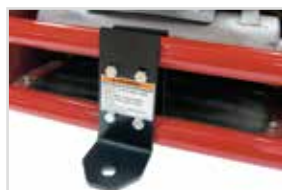
Priključak za vuču Prihvaća kuglu za vuču s navojem 12 mm ili se koristi sa standardnim klinom za vuču.
